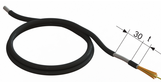
Slika 25 Skinite otprilike 30 mm kabela sa zaštitom od elektromagnetskih polja prije priključivanja na ploču s kabelskim stezaljkama. Dimenzija „t“ odgovara približnom razmaku pričvrstne obujmice od stezaljke kabela
