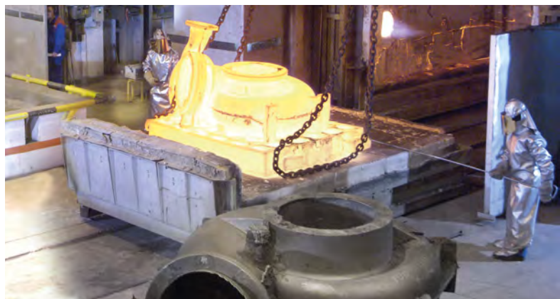
Самые большие отливки, которые могут подвергаться термической обработке в литейном цехе завода в Кархуле, имеют размеры 4500 x 3000 мм.
