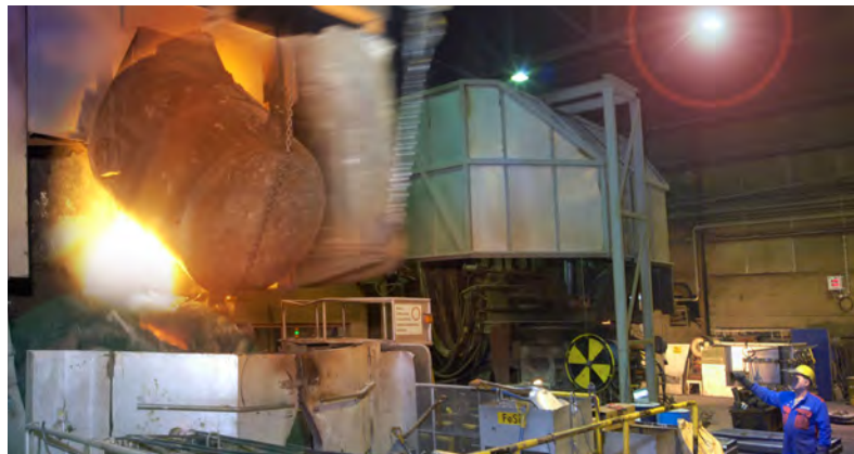
Сталь, полученная при плавке в дуговой печи, обрабатывается в AOD -аргонно-кислородном конвертере (аргонно-кислородное обезуглероживание).
