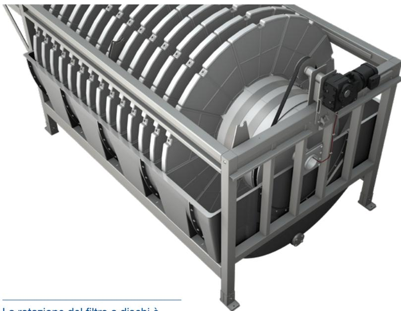
La rotazione del filtro a dischi è attuata da una trasmissione a ingranaggi elicoidali tramite una cinghia dentata rinforzata con fibra di carbonio.
