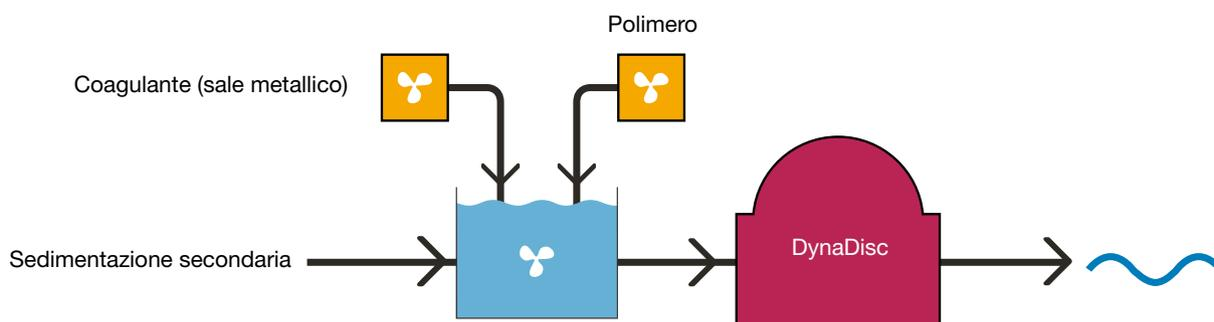
Esempio di diagramma di flusso per Nordic® ZeroP
