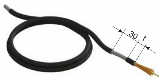
Obrázek 25 Kabel EMC před připojením na kabelové svorkovnici odizolovat v délce 30 mm. Rozměr "t" podle přibližné vzdálenosti od upevňovací příchytky ke kabelové svorce
