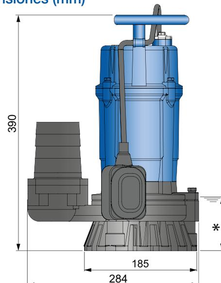
\* 85 mm lámina de agua funcionamiento continuo
