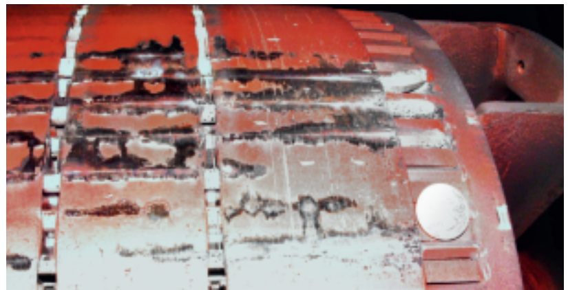
3 Foto des anhand der Vibrationsdaten in Bild 1 und 2 identifizierten beschädigten Rotors.
