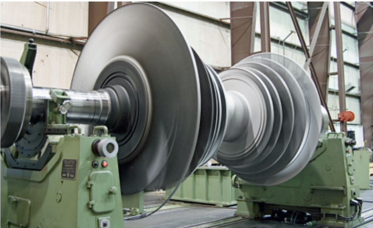
11 Der reparierte Rotor beim Auswuchten.
