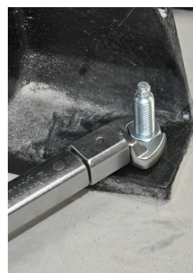
Obrázek 9d: Utáhnutí matice
