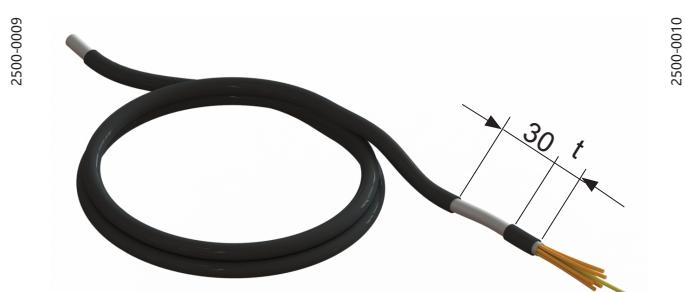
图24 电缆接线前如图剥去30毫米绝缘外皮, 尺寸 "t" 取决于电缆卡扣离电缆接线端子的距离
