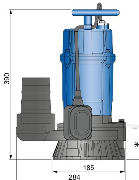
\* Livello dell'acqua a funzionamento continuo 85 mm
