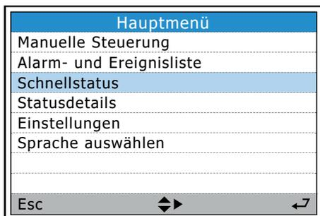
Durch Drücken der Eingabetaste im Schnellstatus werden die Untermenüs wie folgt geöffnet.
