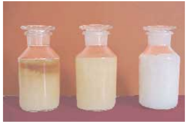
2 ■ Der Grundstoff zur Gewinnung von Paraffin, der sogenannte Paraffin-Gatsch, ist ein Abfallprodukt der Schmierölproduktion, das in unterschiedlichen Zusammensetzungen anfällt.
