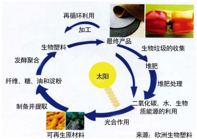
1 生物基塑料的寿命周期。苏尔寿化工技术允许加工高纯度交酯作为聚交酯(PLA)的原材料，这一生物塑料用途广泛。
