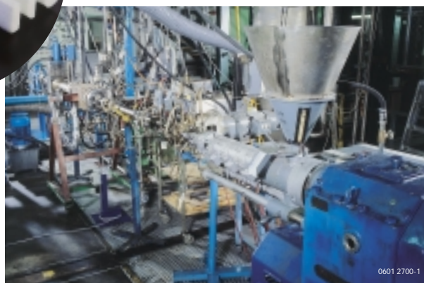
3 Das Polystyrol-Produkt EPS (Expandable Polystyrene) wird als Grundstoff für Gegenstände wie z.B. Verpackungsboxen verwendet. Sulzer Chemtech hat ein kontinuierliches Verfahren zur Produktion dieser Mikrogranulate entwickelt.
