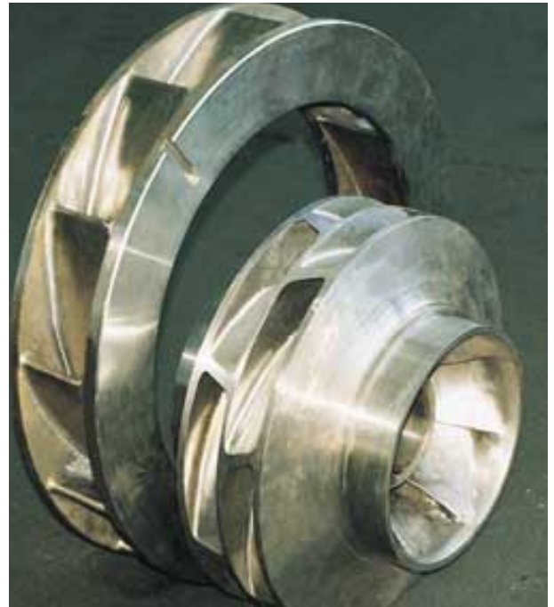
5 ■ Ein Diffusor (links) und ein Laufrad (rechts) einer HSD-Pumpe: Die Schaufeln am Laufradaustritt sind um 20 bis 30 Grad verdreht angeordnet. Dies ist einer der Faktoren, die zu einem gleichmäßigen Lauf der Pumpe beitragen.
