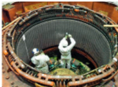
a) Erfassung der ursprünglichen Wicklungsdaten
