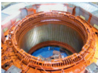
f) Fertige Statorwicklung
