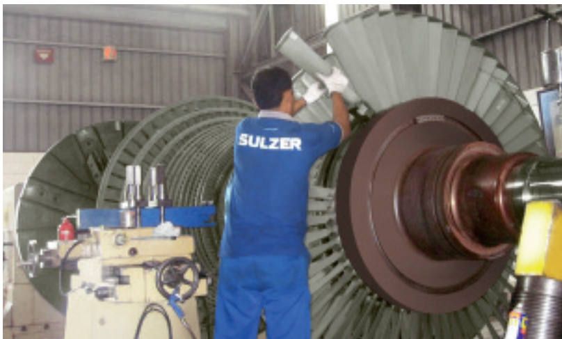
1 Der Kunde entschied sich für die Sulzer-Lösung, die sich durch kürzere Lieferzeiten und verbesserte Schaufeln auszeichnete. Das Bild zeigt die Montage der reparierten Schaufeln der letzten Stufe.
