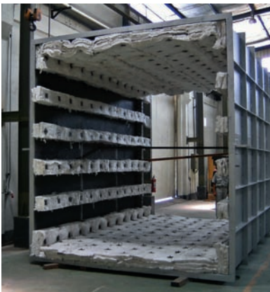
7 Die Abgasschalldämpfermodule wurden nach Vorgaben von Sulzer Turbo Services neu gefertigt.
