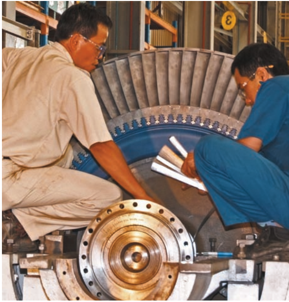
4 Montage der Turbine in der Werkstatt.
