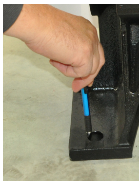
Εικόνα 8a: Σήμανση των οπών
