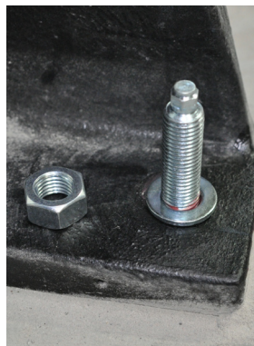
Imagem 9c: Posicionar a anilha
