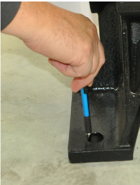
Imagem 8a: Marcar os orifícios de perfuração
