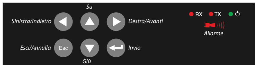
Figura 1-2 I pulsanti freccia consentono di navigare nei menu. Per "entrare" in una voce di menu, premere il pulsante Destra/Avanti o il pulsante Invio. Per confermare un'operazione, premere il pulsante Invio. Il pulsante Esc annulla l'operazione corrente o porta direttamente all'immagine panoramica dell'impianto. La spia verde indica che l'unità è accesa. Le spie Rx e Tx si accendono solo durante la comunicazione (rispettivamente per la ricezione e la trasmissione). La spia di Allarme rossa lampeggia in presenza di un allarme non riconosciuto (il display indica il tipo di allarme). Non appena l'allarme viene riconosciuto, la spia rimane accesa fissa e resta tale finché la causa dell'allarme non viene rimossa.
