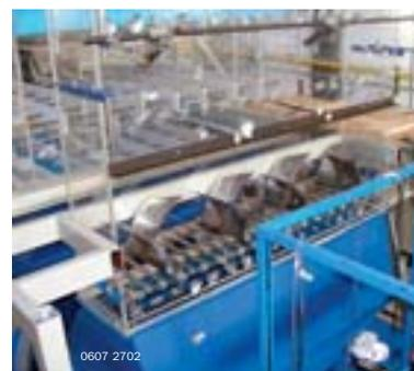
**6** Versuchsaufbau für die Untersuchung des Contour-Mischer. Gemessene Geschwindigkeitsverteilung und Tröpfchendichte stimmten gut mit den Ergebnissen der CFD-Studie überein.
