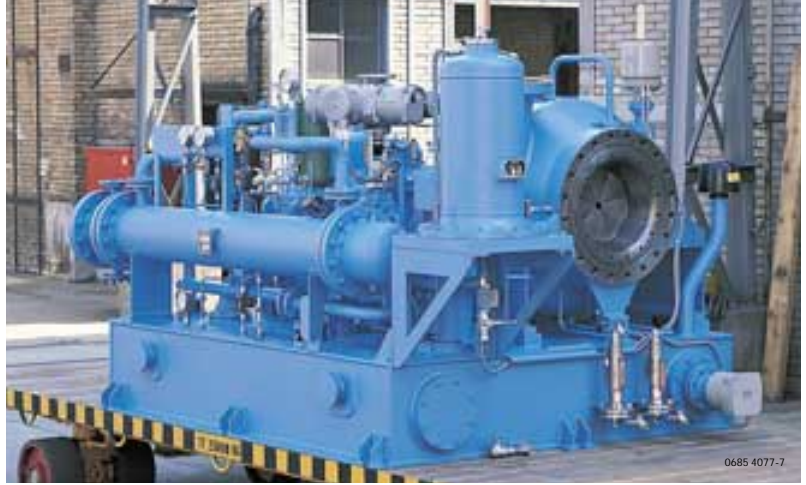
3 ■ Dieser einstufige Radial-Turboverdichter von Sulzer eignet sich beispielsweise zur Verdichtung von 1-Buten oder Isobutan.
