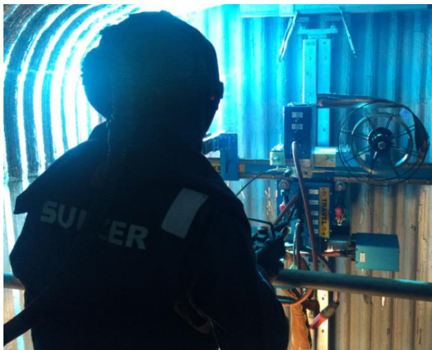
Рис 1: Процесс автоматической наплавки Sulzer CladFuse™
