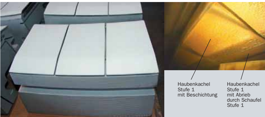
3 Innenhaube einer Gasturbine, frisch beschichtet mit einer Wärmedämmschicht von Sulzer Turbo Services (links). Das Bild nach 18 000 Betriebsstunden zeigt die Einlauffähigkeit des Beschichtungssystems.
