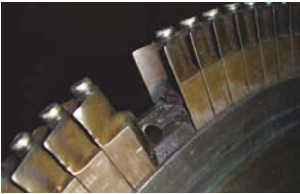
1 Dampfturbinschaufelungs- und Deckbandhavarie. Sulzer Turbo Services reparierte diese Dampfturbine einer australischen Raffinerie in nur 10 Tagen.
