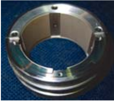
3 Das Flexure-Pivot-Gleitlager ergibt wegen der engen Bearbeitungstoleranzen für die summierten Lagereinbaumasse eine Nulltoleranz.
