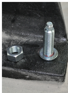
Рис 9с. Размещение шайбы
