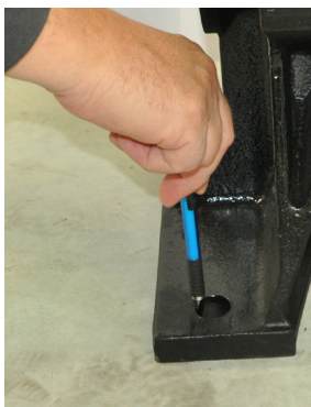
Рис 8а. Маркировка отверстий
