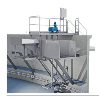
该款刮泥机可以配备圆周表面刮泥机,由底部刮泥机臂提供支撑。表面刮泥机将表面浮渣收集在浮渣盒单元中,该浮渣盒单元安装在混凝土墙上。再通过混凝土墙中的管道将浮渣盒中的污泥排走。
