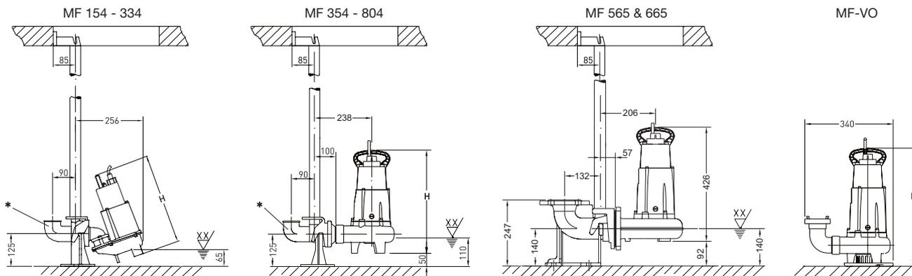
XX/ = Nivel más bajo de desconexión. El nivel mínimo de conexión es al menos 100 mm superior.
