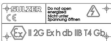
Slika 2 Označna pločica ATEX
