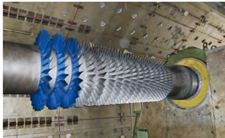
Abb. 2 Verlängerung der Lebensdauer von Rotorschaukeln durch metallisch-keramische Beschichtung (blau).
