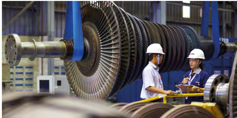
Abb. 5 Turbinenreparatur im Purwakarta Service Center, Indonesien.
