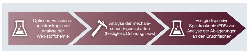
Abb. 3 Materialanalyse der beschädigten Bauteile.
