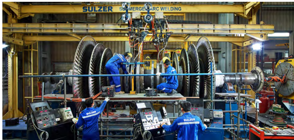
Abb. 7 Schweissschleifung einer Dampfturbine mit 12Cr bei Sulzer Turbo Services in Indonesien.
