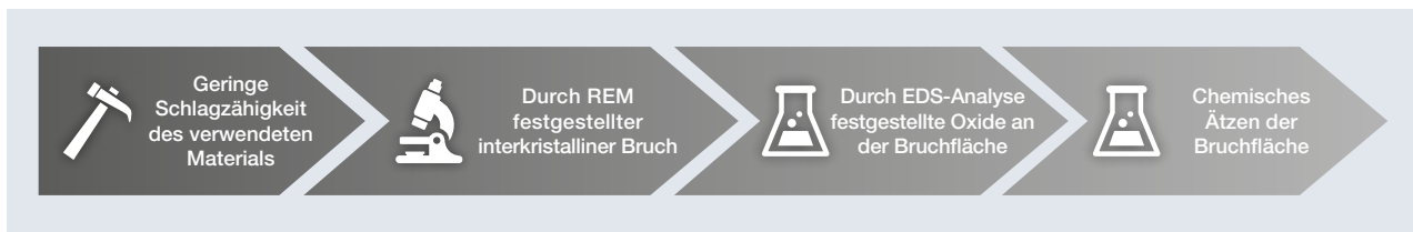
Abb. 6 Fallspezifische Analyse und Ergebnisse zur Rissbildung im Schaufelfussbereich der Rotorscheibe.
