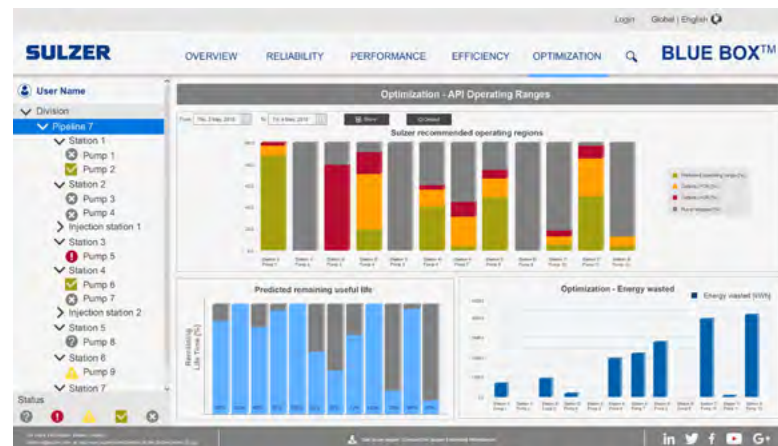
Abb. 4 Analyse des Optimierungspotenzials für einzelne Pumpen und die gesamte Pipeline.
