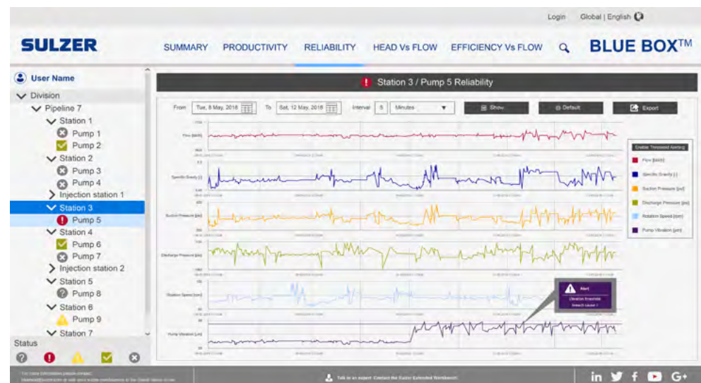
Abb. 5 Korrelation von Pumpendaten mit Warnung bei Überschreiten des Schwingungsgrenzwerts.
