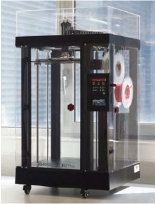
Abb. 3 FDM-Drucker mit rotem PLA als Werkstoff.
