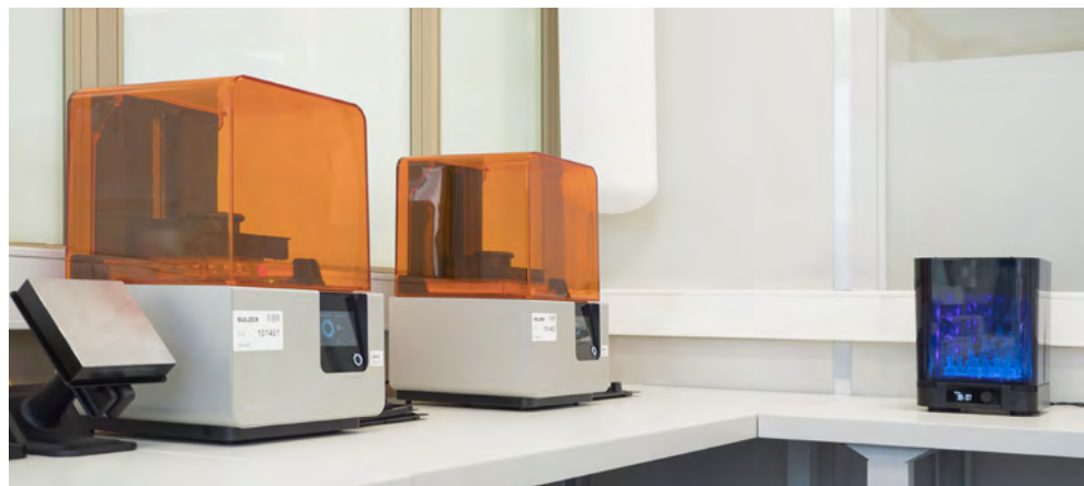
Abb. 2 Zwei Stereolithografie-Drucker (links) mit einer Aushärtungsanlage (rechts).
