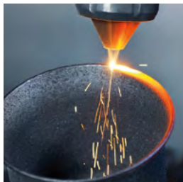
Abb. 5 Additiver Materialaufbau beim Laserauftragschwei- sen (LMD).
