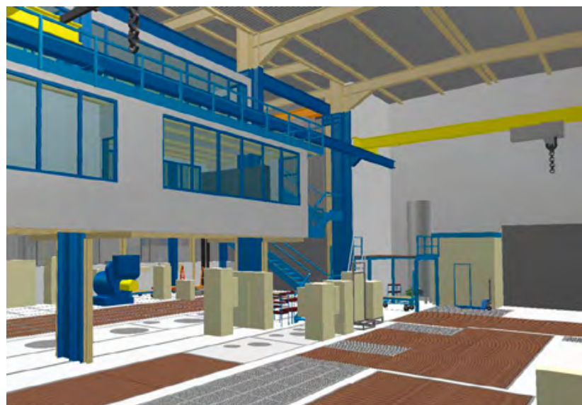
2 Die neue Leitwarte mit Fenstern wird sich über dem Prüfstand befinden.
