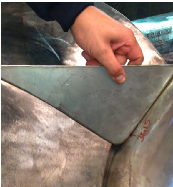
7 Schablone zur Positionierung der Schaufeln beim Schweiessen.
