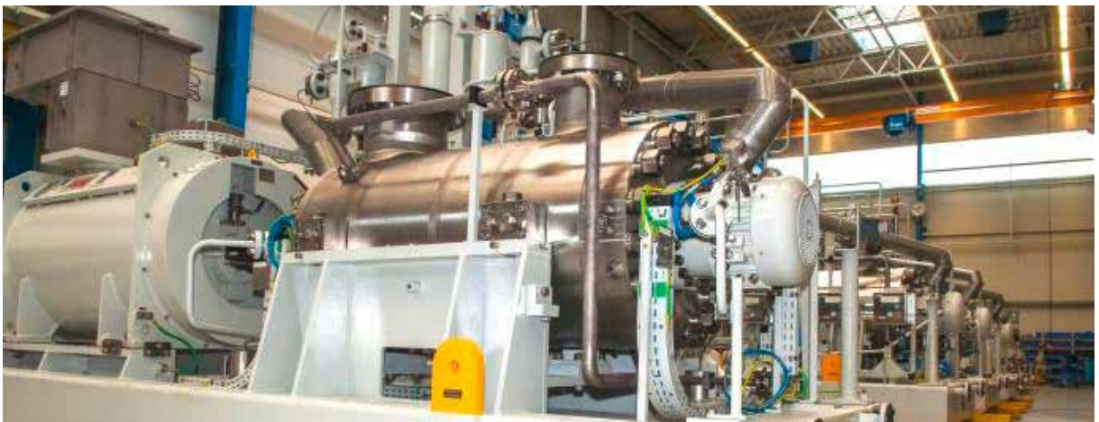
In Bruchsal gefertigte Kühlwasserpumpen vom Typ GSG.
