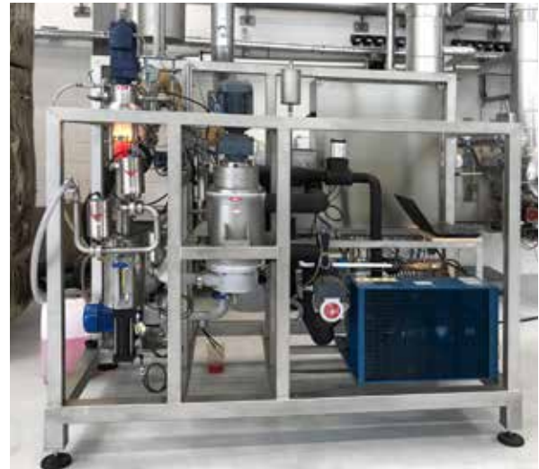
6 Pilotanlage im Testzentrum für Kristallisationsversuche in der Schweiz.
