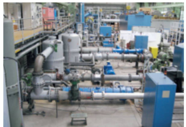
[3] Mit sieben Prüfkreisläufen bietet der Prüfstand in Oberwinterthur (CH) ein hohes Maß an Flexibilität.
