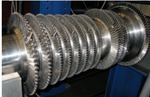
Der sich im Montageprozess befindliche Turbinenrotor.
