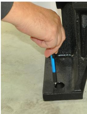
Bild 8a Bohrlöcher markieren
