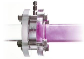
Abbildung 1. CompaX-Statikmischer mit violetten Additiven. Vollständiges Vermischen nach etwa 3D stromabwärts
