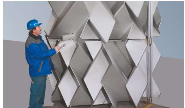
SMV-Mischer für das Mischen von Ethylbenzol und Dampf in einer Styrol Produktionsanlage
