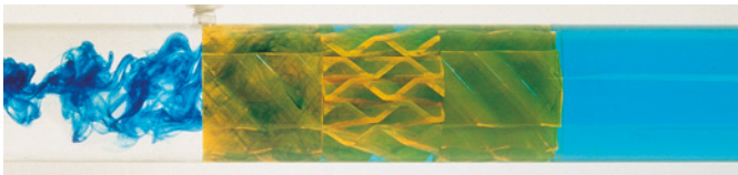
Turbulente Vermischung in einem SMV-Mischer mit 3 Mischelementen.
